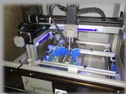
PLATAFORMA 'GANTRY DEL EQUIPO'
