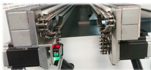
CONVEYOR DE CADENA CON MOTORES PASO A PASO DE PRECISION
