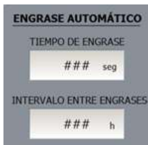
VENTANA DE CONTROL DEL SISTEMA DE AUTOLUBRICACIÓN AUTOLUB
